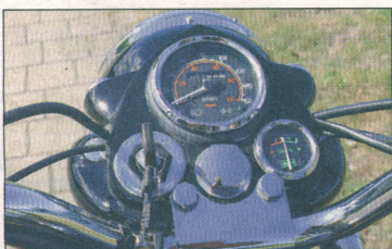
Amperemetret er en uundværlig del af udstyret på mc'en, der startes med kickstarter. Her kan man nemlig se, hvornår stemplet står i rette position, og det dermed er muligt at få gang i den nostalgiske teknik.
