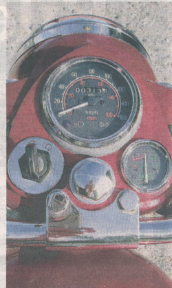
Instrumentering som i 50erne; et integreret lygtehus med ampèremeter til kickstarter. Kilometertælleren står på 333 km!
