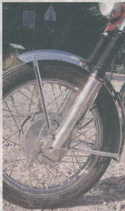
Forgaffel med tressermuffer og tromlebremse. Skivebremse kan fås.
